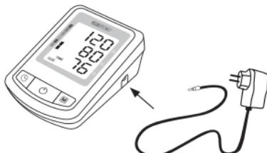
1. Підключите штекер адаптера до гнізда, розташованого в нижній частині приладу. При цьому живлення приладу від батарейок авто-
