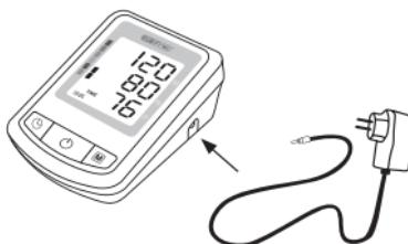
1. Adaptera spraudni ievietojiet ligzdā, kura atrodas iekārtas apakšējā daļā. Barošana no baterijām tiks automātiski atslēgta.
